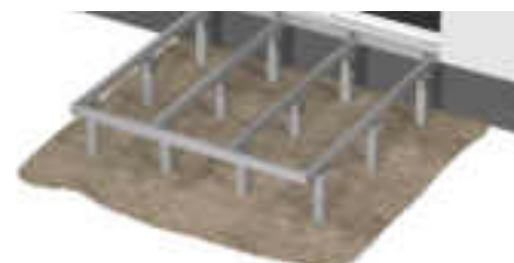
AUFGESTÄNDERT AUF PFOSTEN auch auf sandigen Böden und mit großem Höhenausgleich möglich.
